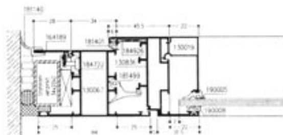
5. ábra. A WICLINE 50N típusú nyíló, nyíló-bukó ablak vízszintes metszete
